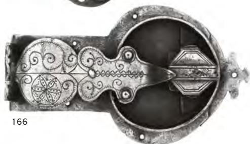
**166. Serrure de coffre** en fer forgé et gravé. Mécanisme à mâchoires et gâchette dont la couverture est gravée d'une rosace et d'enroulements.
