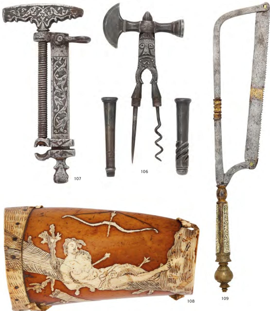
**106. Trousse d'arquebusier** en fer forgé en forme de pince sur laquelle vient se visser une hache à marteau, gravée d'un masque d'homme barbu sur ses deux faces. L'une des branches est terminée par un poinçon s'engageant dans un étui formant tournevis. L'autre est dotée d'une mèche en queue de cochon protégée dans un étui sur lequel se visse un tire-bourre. Une pince est également aménagée à la rencontre des deux branches.
