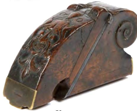
**73. Boutoir de maréchal ferrant** en fer forgé et acier. L'extrémité du porte-lame est terminée par une patte de cheval et la poignée repose sur un fer à planche.
