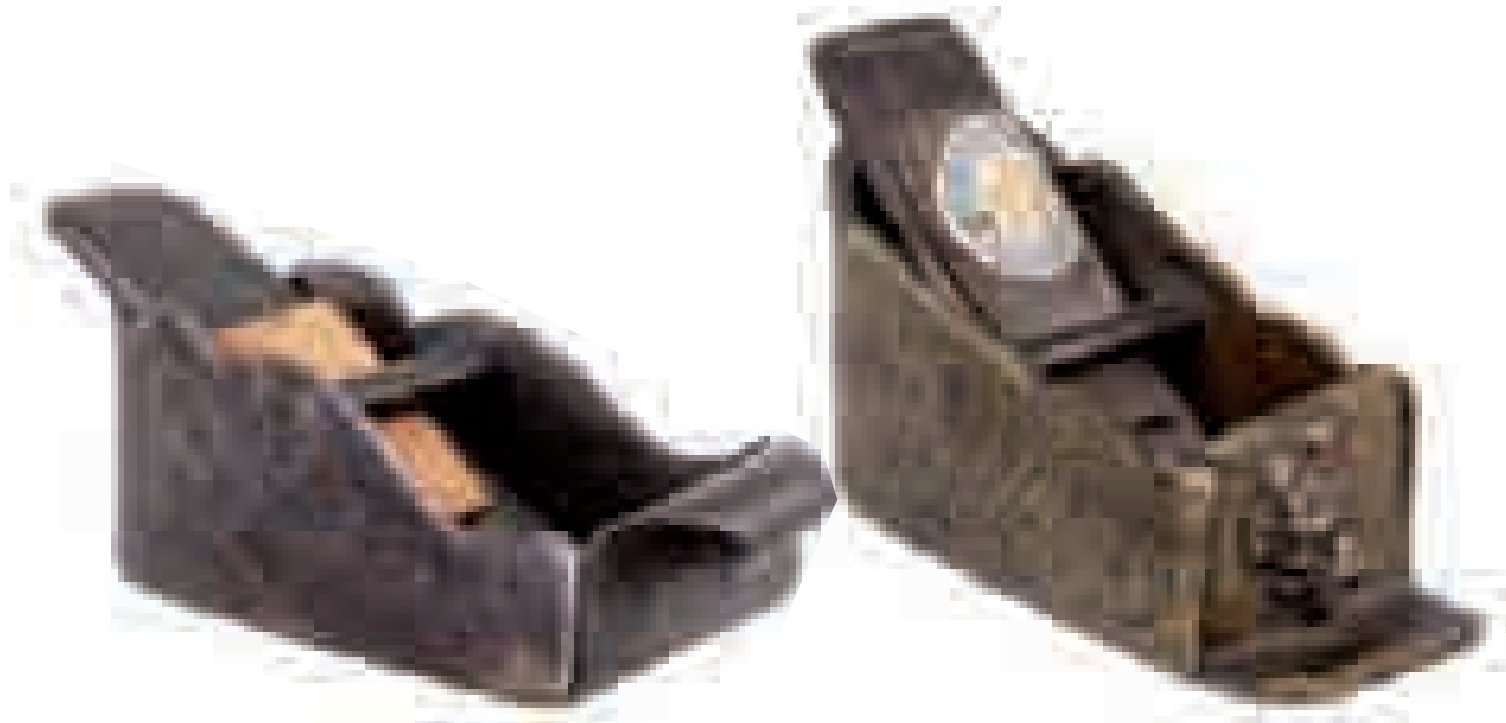
320. Rabot de luthier en fer, de forme trapézoïdale au talon arrondi et au nez terminé par une volute. Son fer est bloqué dans le fût à l'aide d'une entretoise en fer. (Coin postérieur.) Allemagne XVIIe siècle L: 6,4 cm
