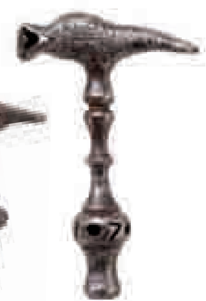
279. Marteau d'arquebusier en fer forgé. À tête ronde et panne en travers, il est pourvu d'un manche en balustre agrémenté d'une bague mobile et terminé par un tournevis. La masse et le manche sont ornés de cannelures. XVIIe siècle H: 9,7 – L: 4 cm
